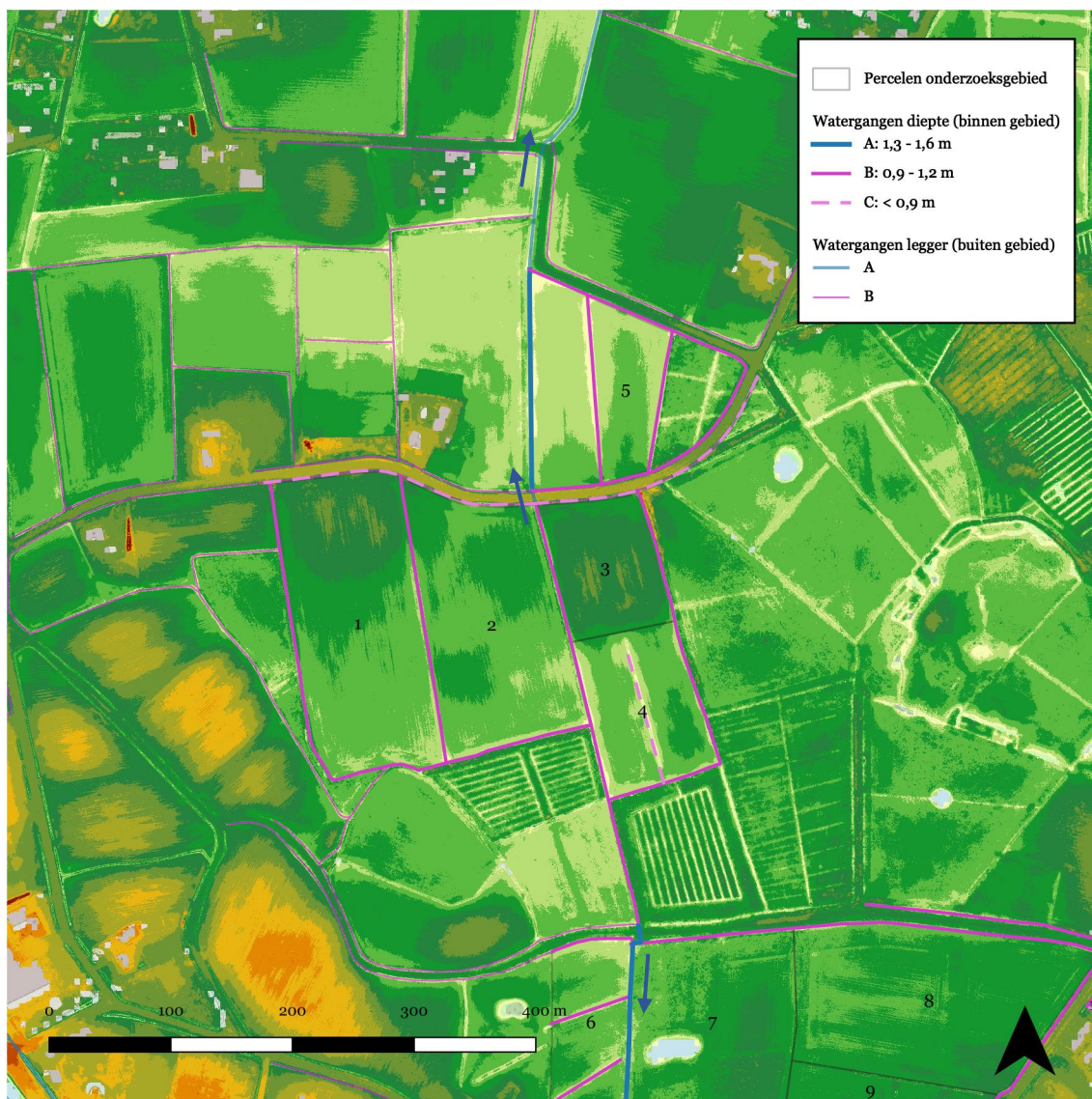
Figuur 5.2 - Watergangen met bodemdiepteklasse van de watergangen in deelgebied Leemskuilen. De ondergrond vertoont de maaienveldhoogtekaart AHN3 met dezelfde kleurenlegenda als figuur 3.1, waarin elk kleurverschil een hoogteverschil van 0,2 bedraagt.
