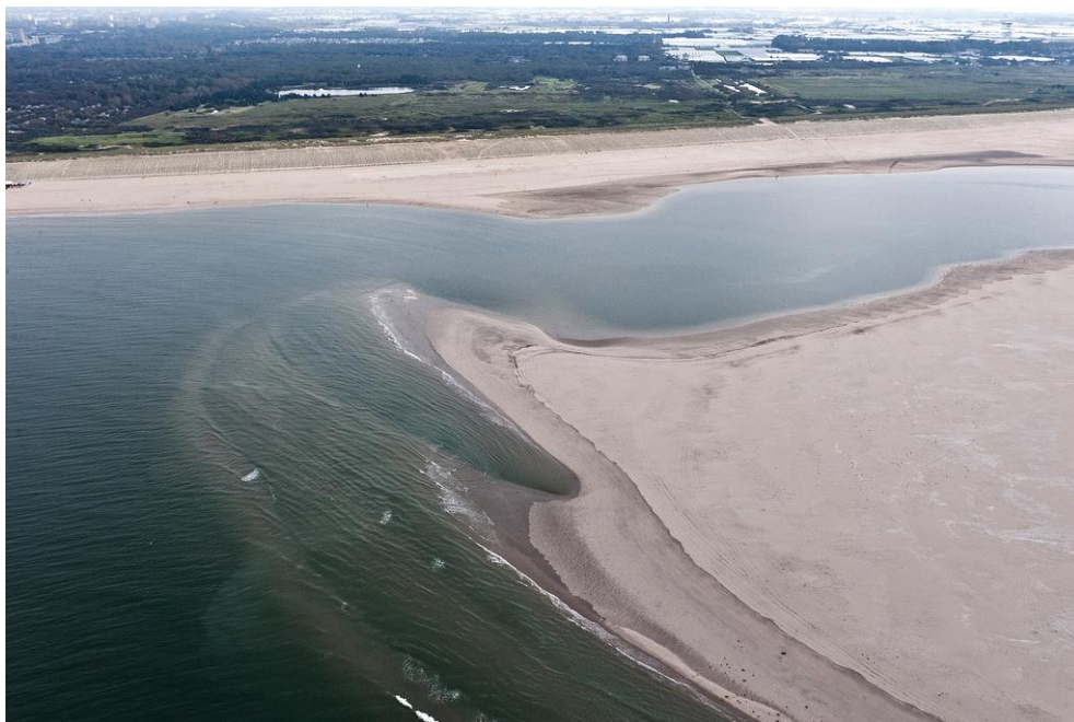
Foto 2: De Zandmotor op 27 september 2011. De baai van de Zandmotor wordt bij de opening aan twee kanten afgesnoerd. Foto Joop van Houdt.
