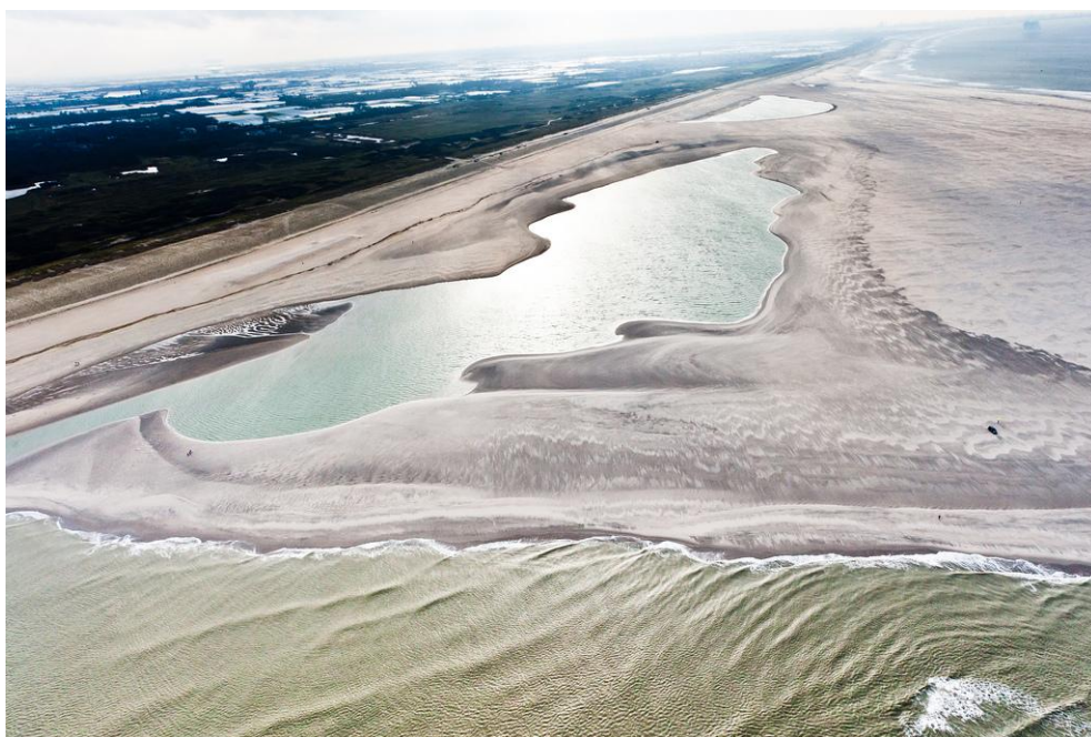
Foto 3: De Zandmotor op 29 november 2011. De monding van baai van de Zandmotor is door een reeks van zandbanken afgesloten. Een smalle getijdengeul vult de baai met vloed en leegt hem met eb. Foto Joop van Houdt.
