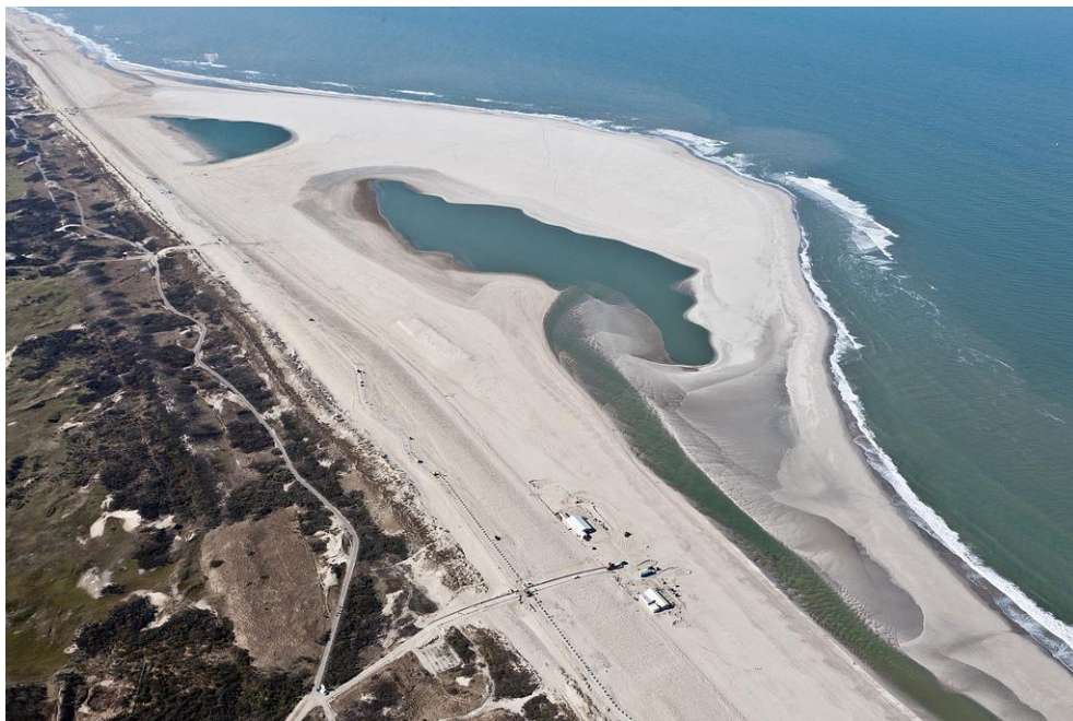
Foto 4: De Zandmotor op 20 maart 2012. De zandbank en geul zijn beiden fors naar het noorden toe gegroeid richting Kijkduin. Foto Joop van Houdt.
