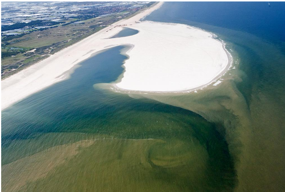
Foto 1: De Zandmotor op 11 juli 2011 vlak na aanleg. Duidelijk is het sedimenttransport te zien en de aangroei van een zandbank vanaf de punt van de Zandmotor. Foto Joop van Houdt.
