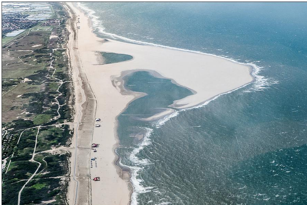
Foto 6: Begin mei is de oude geul afgedamd. Op 14 mei 2012 is zichtbaar dat de gegraven geul (de bovenste op de foto) niet meer de enige is. De zee zelf heeft een nieuwe en veel bredere toegang gemaakt. De dam is nauwelijks zichtbaar en wordt aan drie kanten met zeewater omspoelt. Foto Joop van Houdt.
