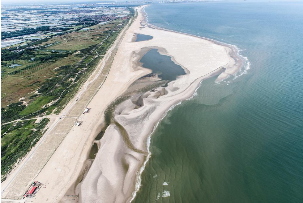
Foto 3: Na een jaar Zandmotor zijn op 2 juli 2012 bij eb de grote veranderingen op de Zandmotor goed zichtbaar. De Zandmotor is flink naar het noorden gegroeid, via een getijdengeul houdt de bijna afgesloten baai contact met het wisselende waterpeil op de Noordzee. Vanwege de hoge stroomsnelheid in de geul is deze afgedamd en is er een nieuwe, kortere verbinding met de Noordzee. Foto Joop van Houdt.
