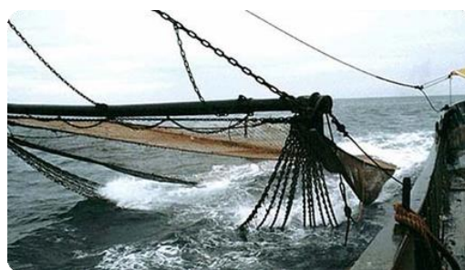
Figuur 7 Boomkorvisserij met wekkerkettingen, verkregen: http://www.ecomare.nl/ecomare-encyclopedie/mens-en-milieu/visserij/visserijtechnieken/boomkorvisserij/
