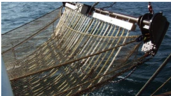
Figuur 12 Pulsvisserij verkregen: http://www.vvd-urk.nl/?p=580
