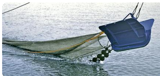
Figuur 8 Enkelvoudige spanvisserij met scheerborden verkregen: http://www.ecomare.nl/ecomare-encyclopedie/mens-en-milieu/visserij/visserijtechnieken/borden-visserij/
