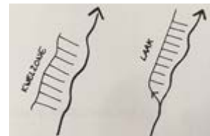
Twee principes van bevloeien. Links vanuit het aansnijden van een kwelbron of zone, rechts met opgeleid beekwater vanuit een gegraven laak 138 .
