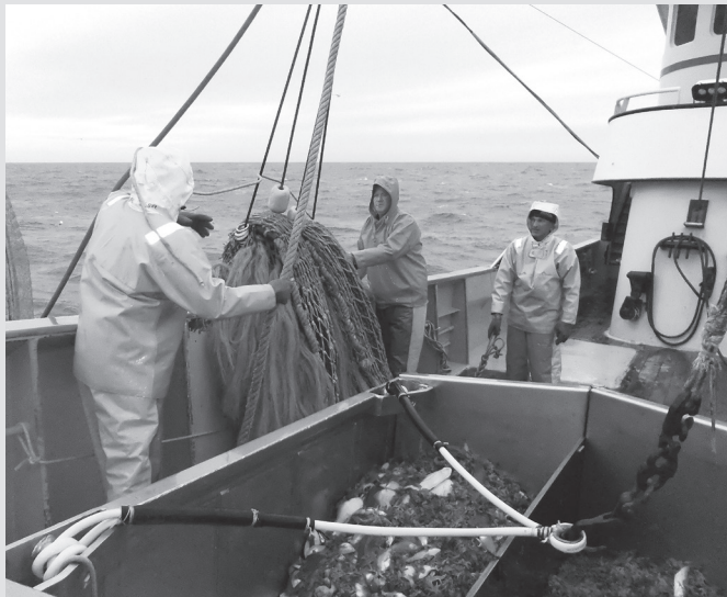
★ De twee kuilen van het stuurboordnet zijn afzonderlijk geleegd. In de stortbakken is een scheiding aangebracht om de vangsten van de verschillende kuilen te vergelijken.
