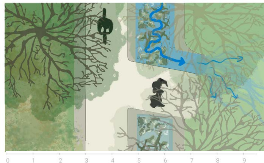
Vue de dessus de la manière dont l'eau peut être déviée des chemins creux.
