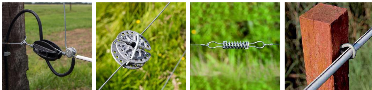
Figuur 6: Hoekisolator, roterende spanner, trekveer, insul timber (overgenomen van Gallagher)
